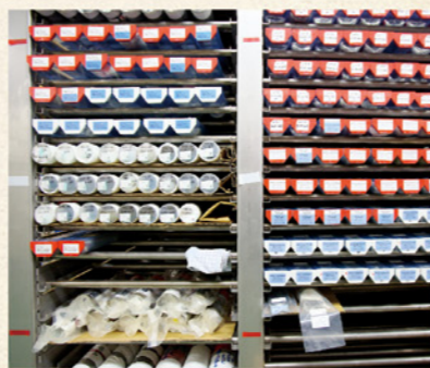
冷蔵倉庫に保管されている大量の海洋コア
