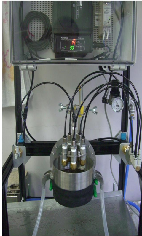
図-1 人工降雨装置に装着した土壌試料（円筒内）
