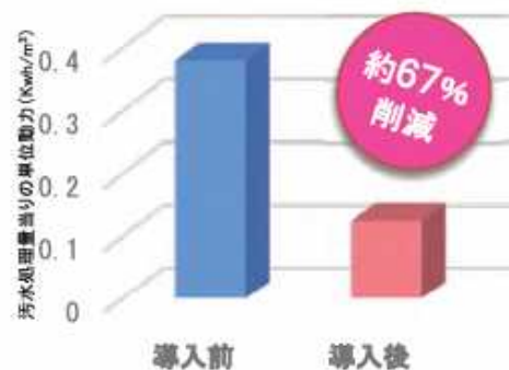
野市浄化センターでの実証試験 における消費電力削減効果
