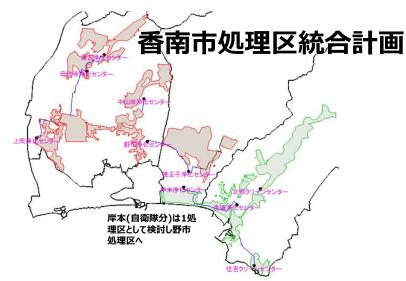
香南市汚水処理の持続性向上のため、処理区統合計画を策定(11→2カ所)。実現のために本技術を野市浄化センター、夜須浄化センターに導入
