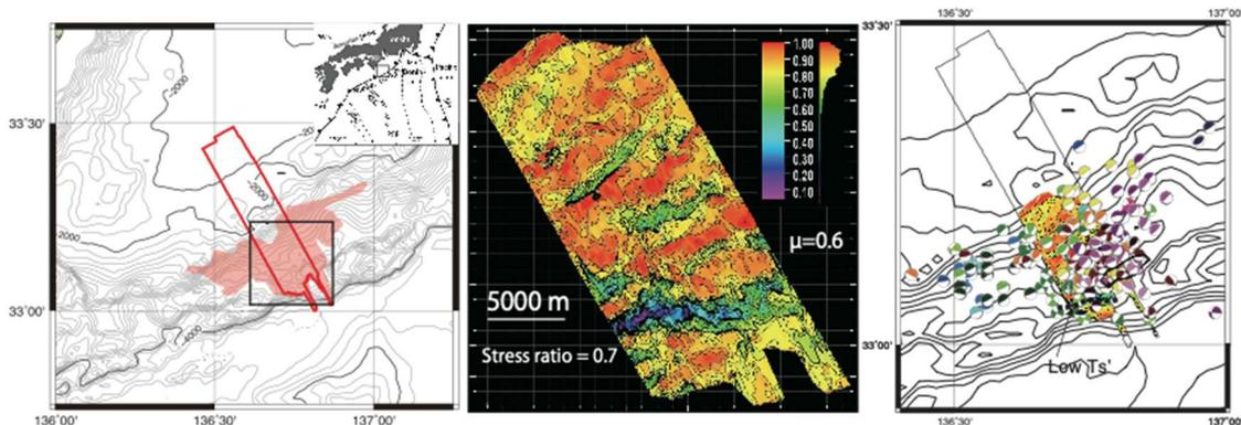
左図：赤線は紀伊半島沖南海トラフ3次元地震波反射断面の領域（本研究の地形解析に使用）、赤領域は超低周波地震（VLFE）の分布、黒線の四角は中央図の解析範囲を示します。
