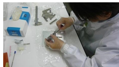
質量分析装置の イオン検出器を分解し 特定の元素用に調整作業中
