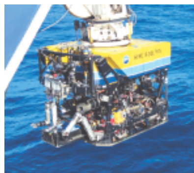
現場化学センサ群を搭載した無人探査機「ハイパードルフィン」
